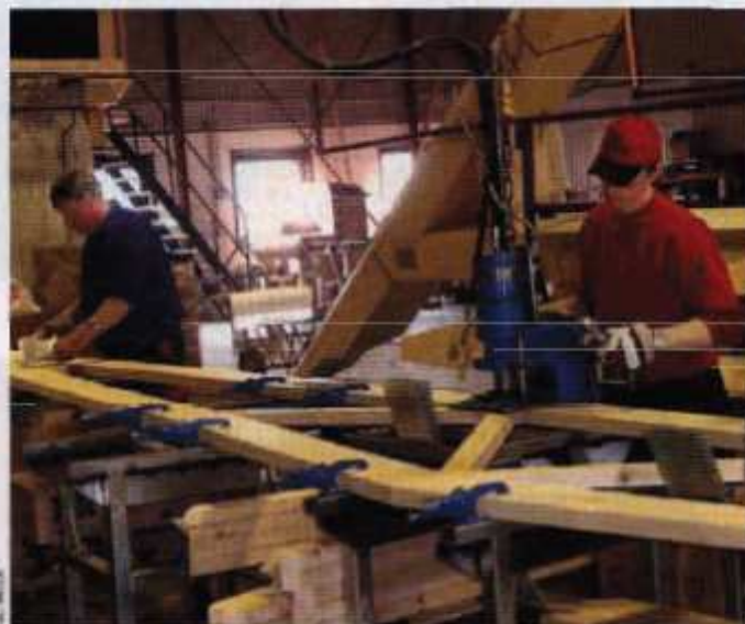
4 Łączenie poszczególnych elementów więźary płytkami kolczastymi; specjalne stoły-szablony gwarantują powtarzalność elementów
