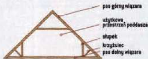
▲ ▲ DACH DWUSPADOWY – BEZ ŚCIANEK KOLANKOWYCH
