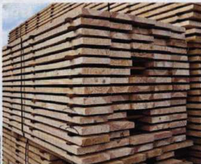
2 Drewno przeznaczone do wykonania prefabrykowanych więźarów; każdy bal powinien być ostemplowany symbolem klasy wytrzymałości C24
