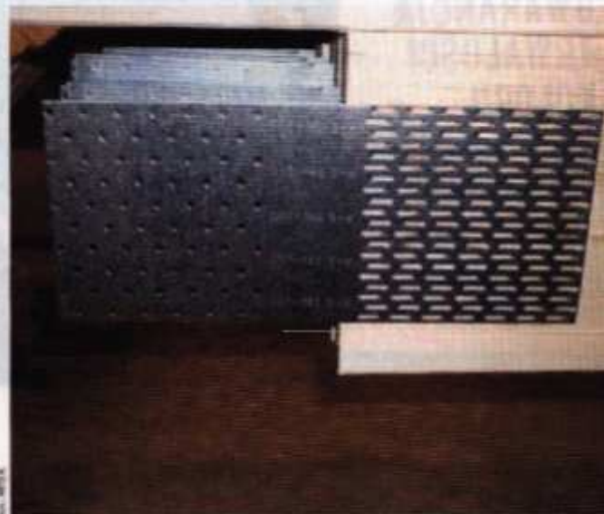
5 Płytki kolczasto-gwoździowane; część kolczastą wciska się w drewno w wytwórni, część gwoździowaną mocuje na budowie
